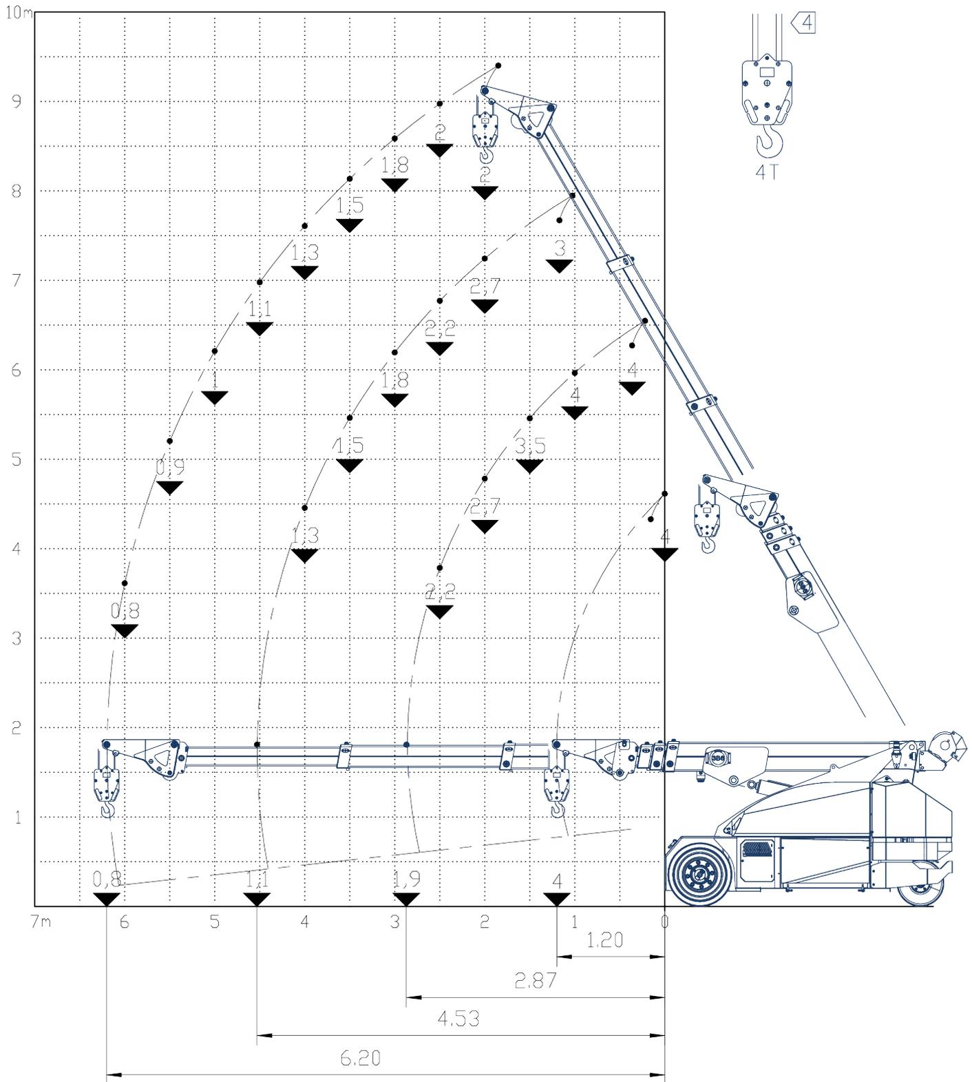
**Flèche de base + Jib mécanique 4t + allonge de jib , inclinable 3 positions 0-22-45°**
