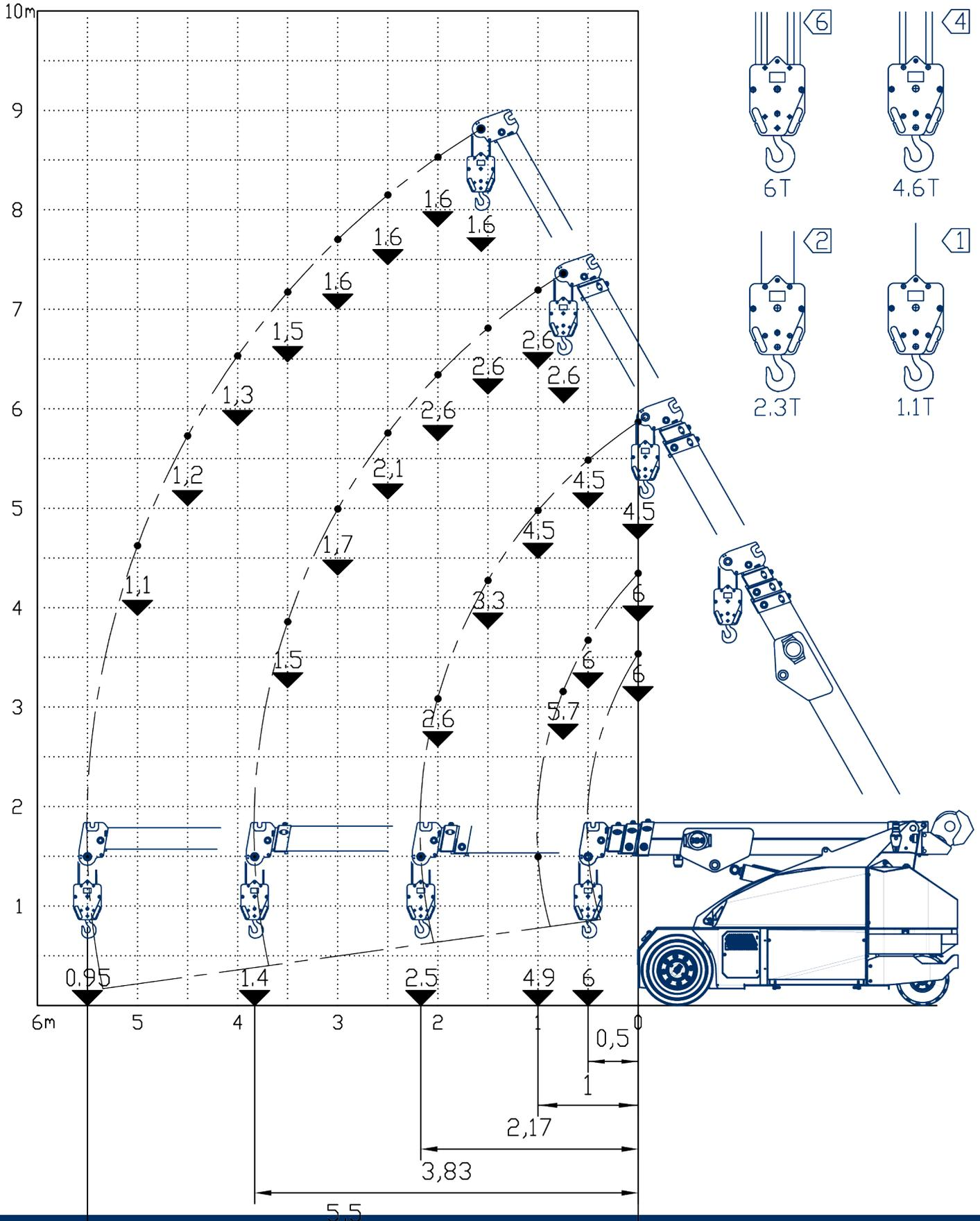
**Flèche de base + Jib mécanique 4t, inclinable 3 positions 0-22-45°**
