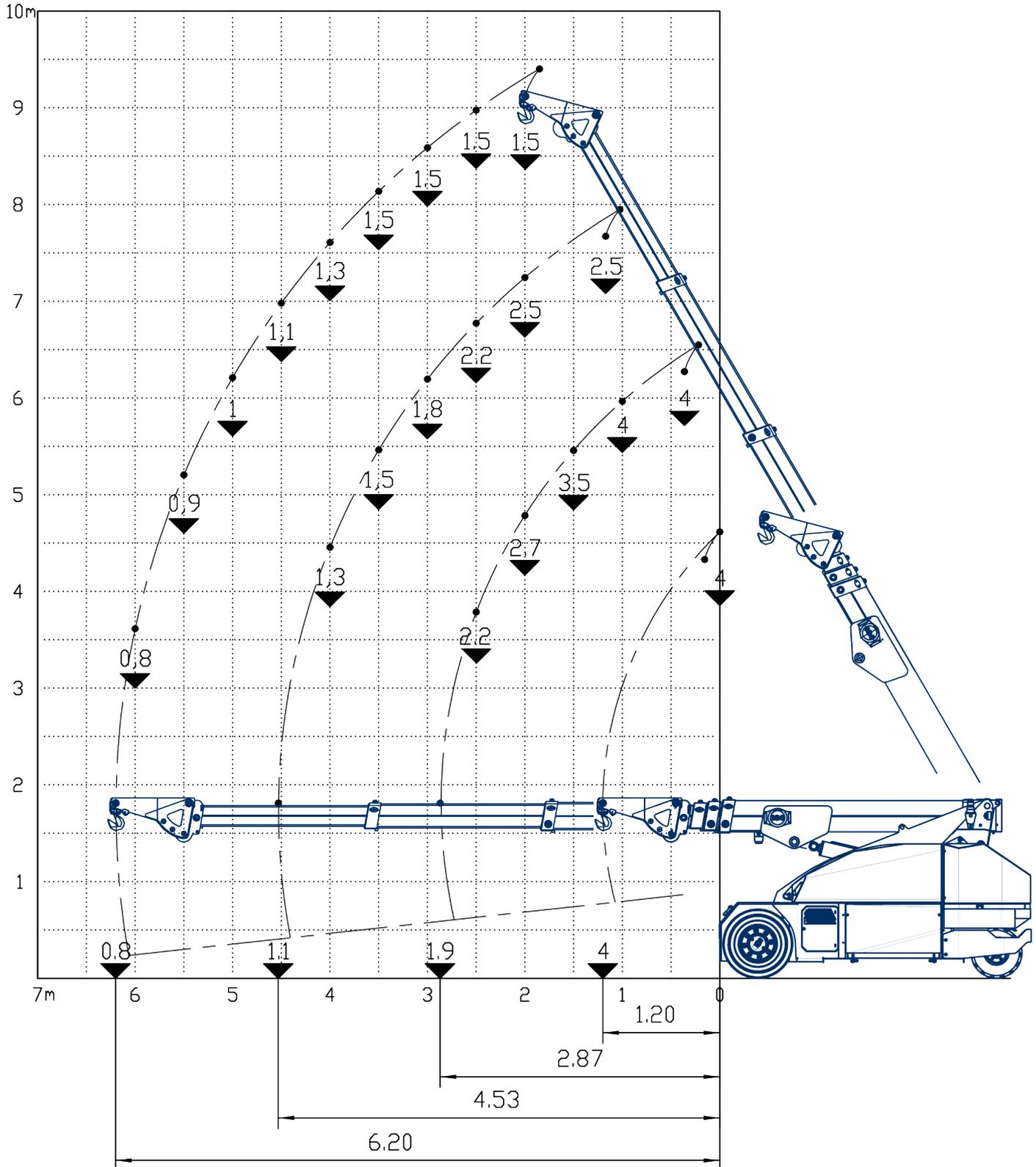
**Flèche de base + Jib mécanique 4t avec Treuil, inclinable 3 positions 0-22-45°**
