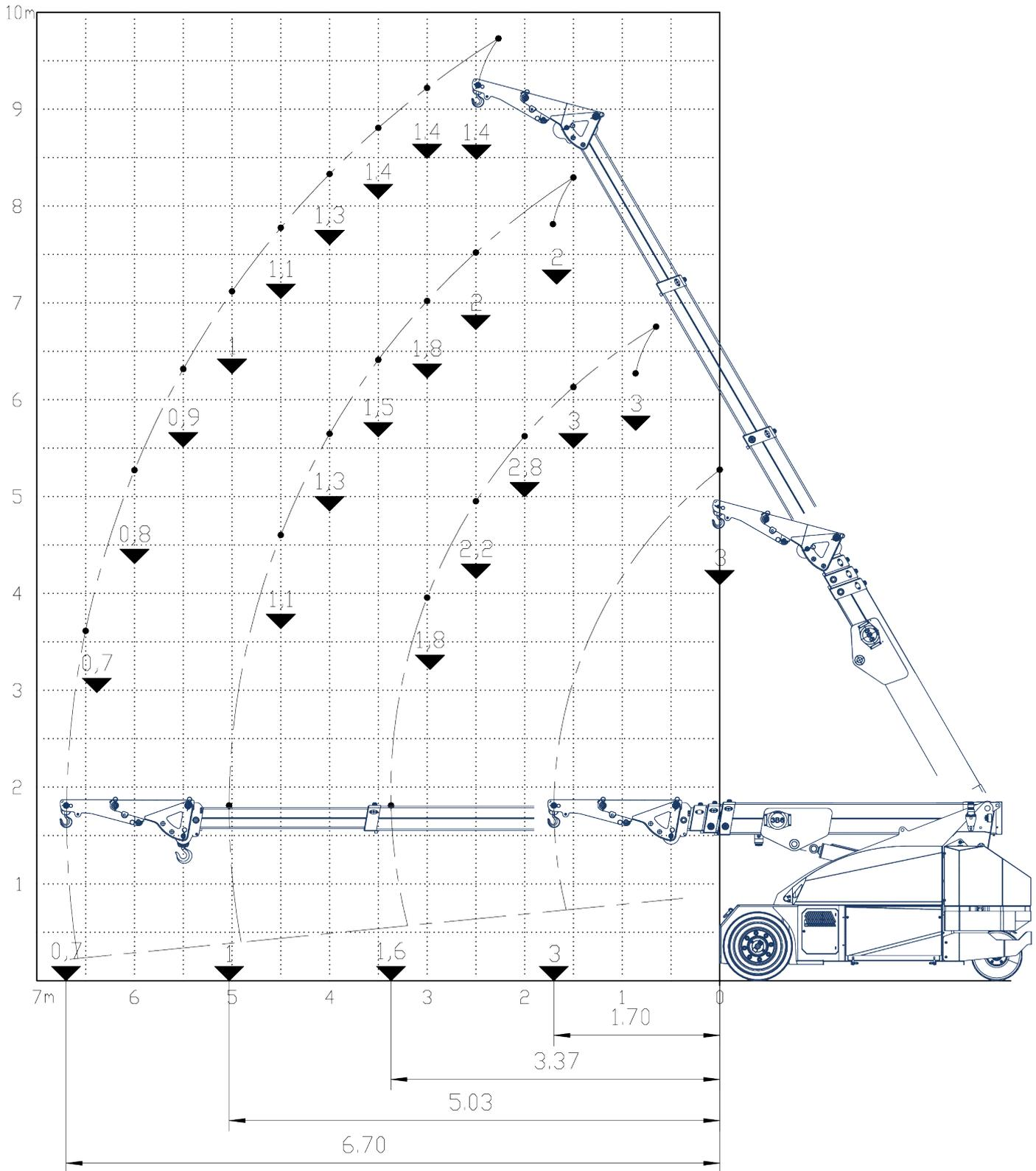
**Flèche de base + Jib mécanique 4t + allonge de jib + treuil , inclinable 3 positions 0-22-45°**
